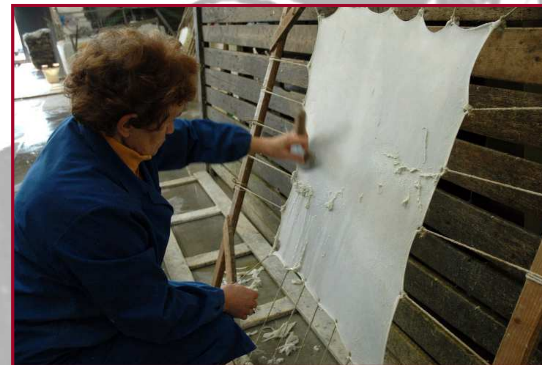
La scarnitura permette l'assottigliamento dello spessore della pelle in modo da renderla più elastica e flessibile.
